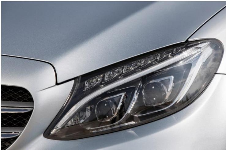
Os faróis conferem distinção à parte frontal de um automóvel, iluminam a pista e deixam o veículo visível a outros usuários da via. No LED Intelligent Light System, da Automotive Lighting, que a Mercedes-Benz está instalando no seu atual veículo Classe C, são empregados três diferentes compostos para moldagem PLEXIGLAS® e PLEXIMID®. Fonte: © Daimler AG
