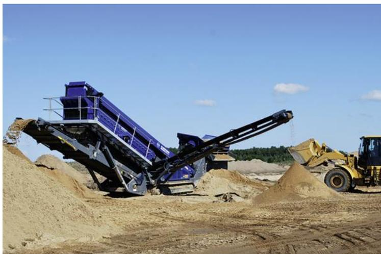
*A unidade móvel de peneiramento na Lituânia economizou três litros de diesel por hora – e ficou mais silenciosa – após a substituição do fluido hidráulico.*
