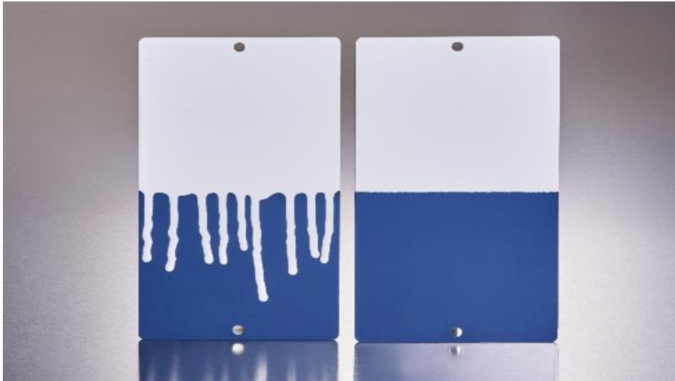
Legenda: O revestimento (à direita) com a adição da sílica pirogênica AEROSIL® se mantém estável; sem o produto (à esquerda), escorre pela parede.
